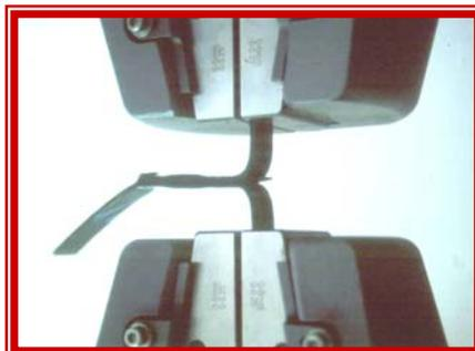
Schälversuche Überlappnaht mit Prüfkanal
