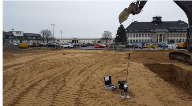
Abbildung 2 Plattendruckversuch
